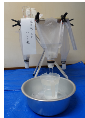
写真2 雨水の粗ろ過中
